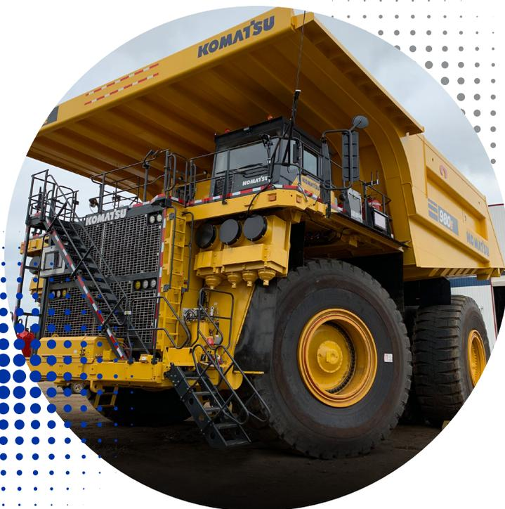
Depuis le début des années 1980, Équipement SMS aide ses clients à atteindre leurs objectifs de cycle de vie et de charge utile des bennes de camion de transport. Équipement SMS a fabriqué et assemblé des bennes de camion pour la roche, le minerai de fer, les sables bitumineux et le charbon, dont la charge utile varie de 120 à 400 tonnes.
